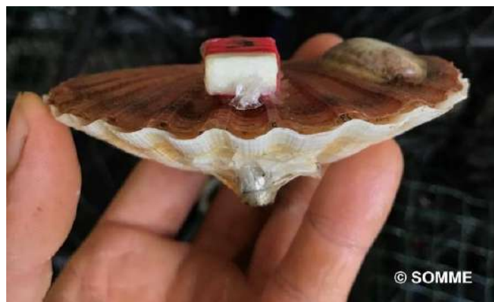
Figure 12 : Coquille Saint-Jacques équipée d'un accéléromètre/valvomètre.
