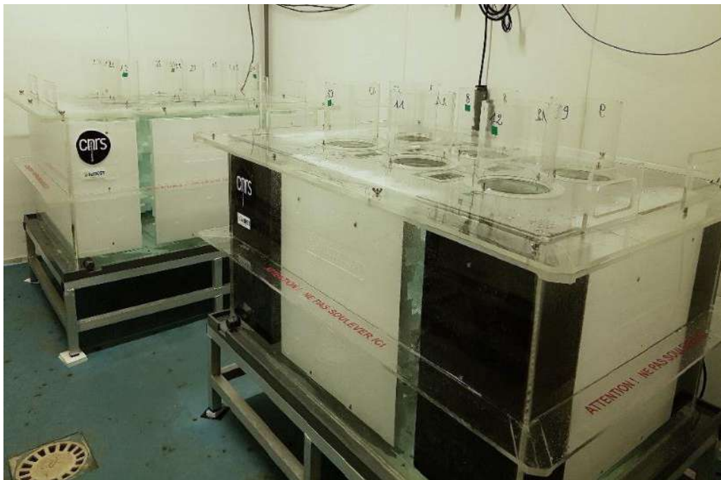
Figure 21 : Deux bassins Larvosonic dans leur configuration expérimentale.
