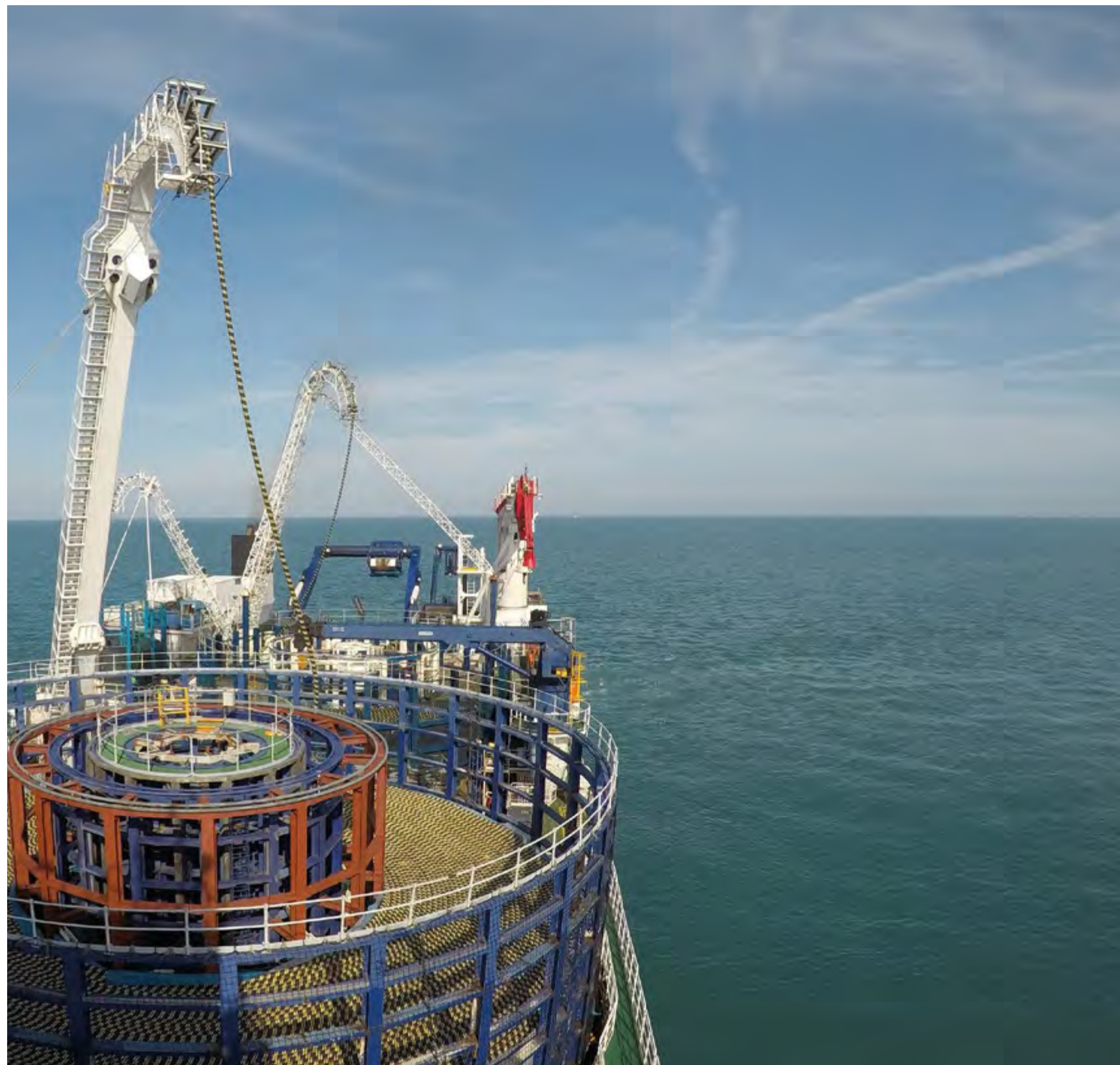
Touret de câble sur un navire câblé
