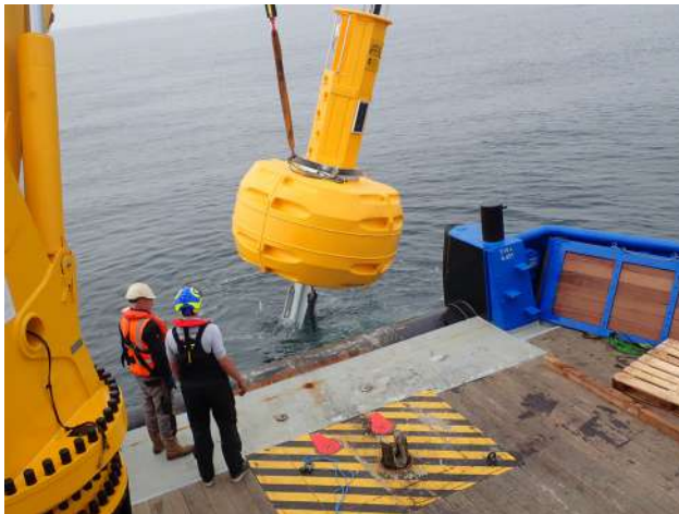
Mise à l'eau d'une bouée pour étudier le biofouling au large de Groix & Belle-Île © France Energies Marines
