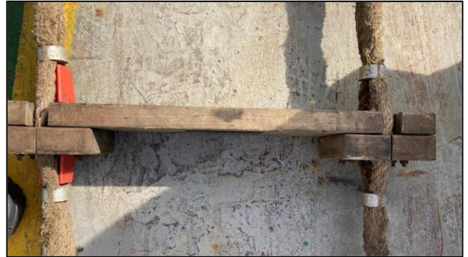
Marche d'échelle du VAN STAR avec entretoises manquantes Source BEAmer
