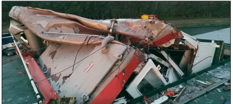
Arrachement et basculement de la timonerie, avec compression du toit - Source VeriTech
