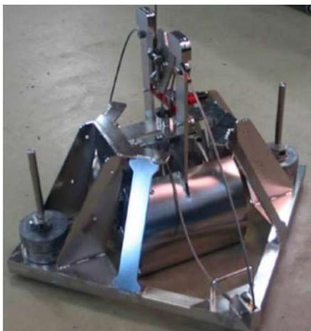
Benne Day Grab (surface de prélèvement : 0,1m<sup>2</sup>)
