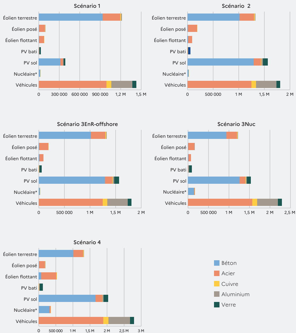
Graphique 16 Besoins matières moyens annuels en tonnes/an entre 2020 et 2050 d'une partie des systèmes énergétiques et des véhicules particuliers et VUL des scénarios prospectifs
