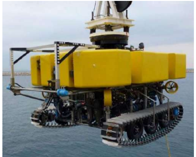
Engin de water-jetting (Crédit photo Rte)
