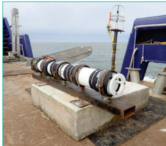
Figure 9 : Enregistreur acoustique autonome (OSEAN) équipé d'un hydrophone et positionné sur un corps mort avant immersion (crédit photo : NEREIS Environnement).
