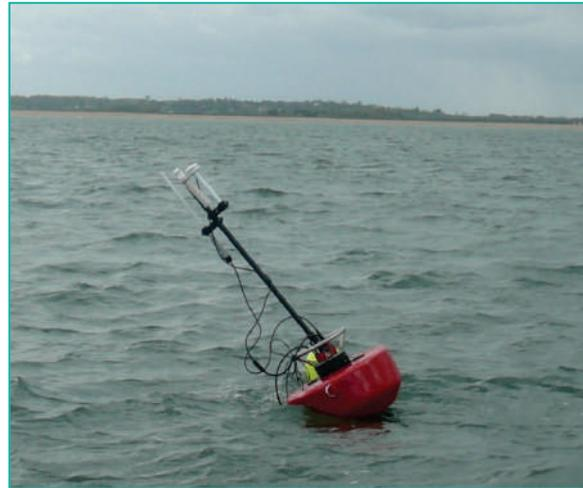
Figure 10 : Bouée acoustique flottante autonome (RTSys - crédit photo : NEREIS Environnement).
