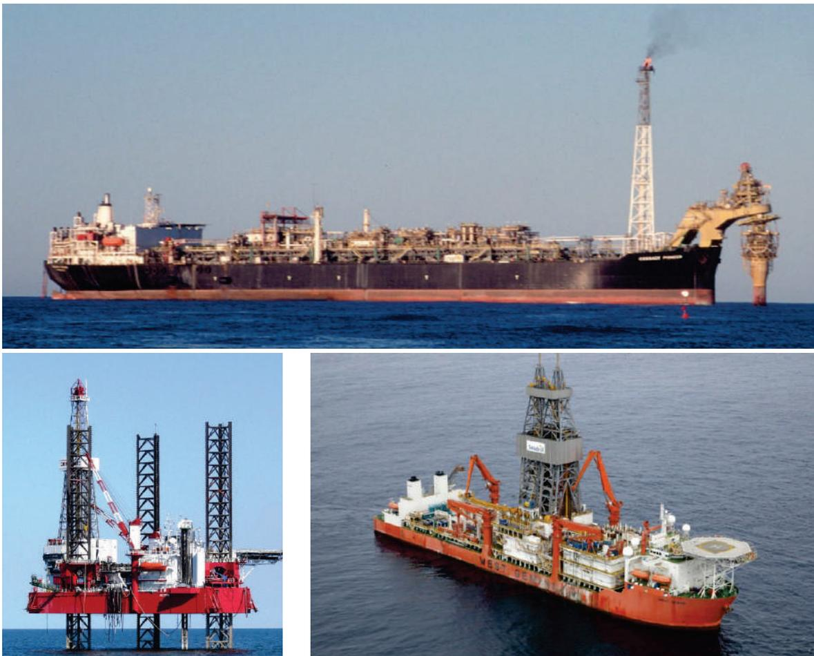
Figure 15 : Plateforme mobile Cossack Pioneer de type FPSO (*Floating Production Storage and Offloading* [60]), plateforme auto-élevatrice Astra (crédit photo : EDC Ltd.) et navire de forage West Gemini (crédit photo : Thierry Gonzalez/TOTAL).
