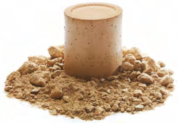
Projet HP2A - Bloc HP2E à base d'argile et de matériaux de récupération
